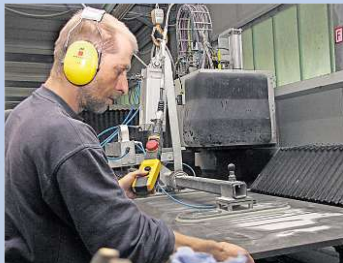
CNC-Bediener Rocco Kostial setzt eine Küchenarbeitsplatte zur Bearbeitung auf. Foto: Marion Gründler
